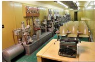
Coche especial de instrucción NdeM 5 "Escuela Frenos de Aire"
